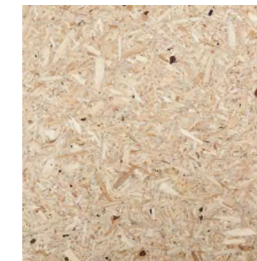
ESB-Platten Grobspanplatten aus emissionsarmen Fichtenholz Innere Außenwandbeplankung
