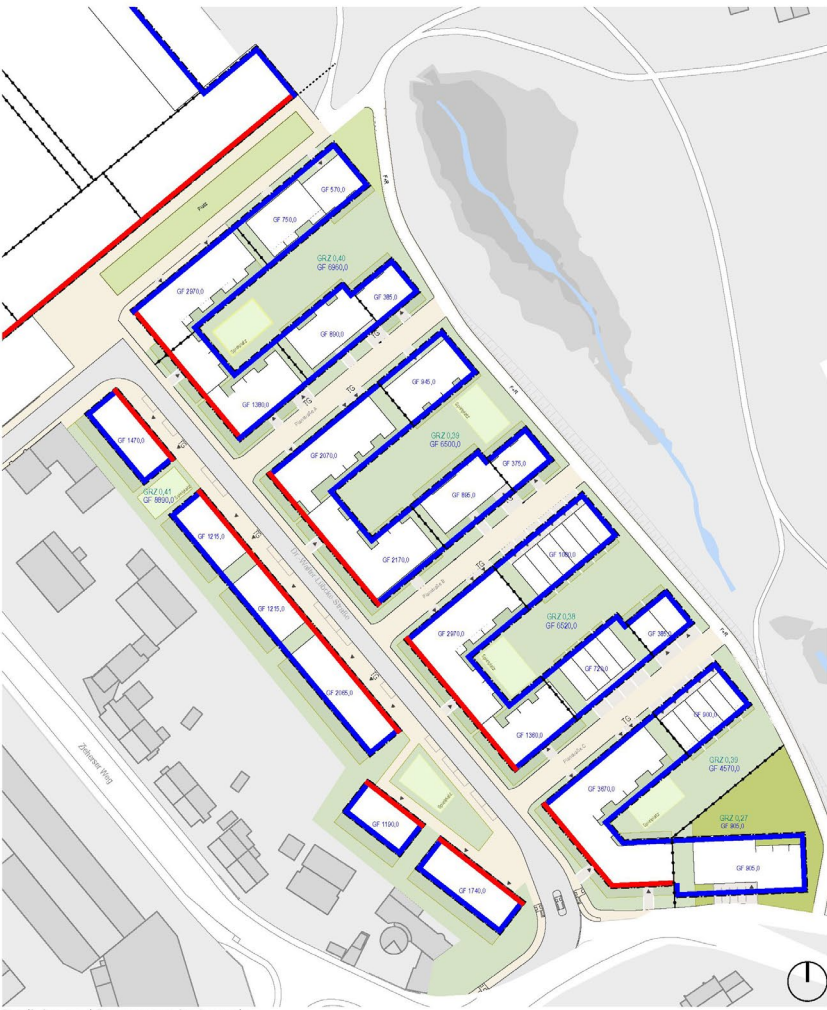
Baulinien und Baugrenzen im Lageplan Nachweis GRZ-Berechnung und GF-Berechnung
