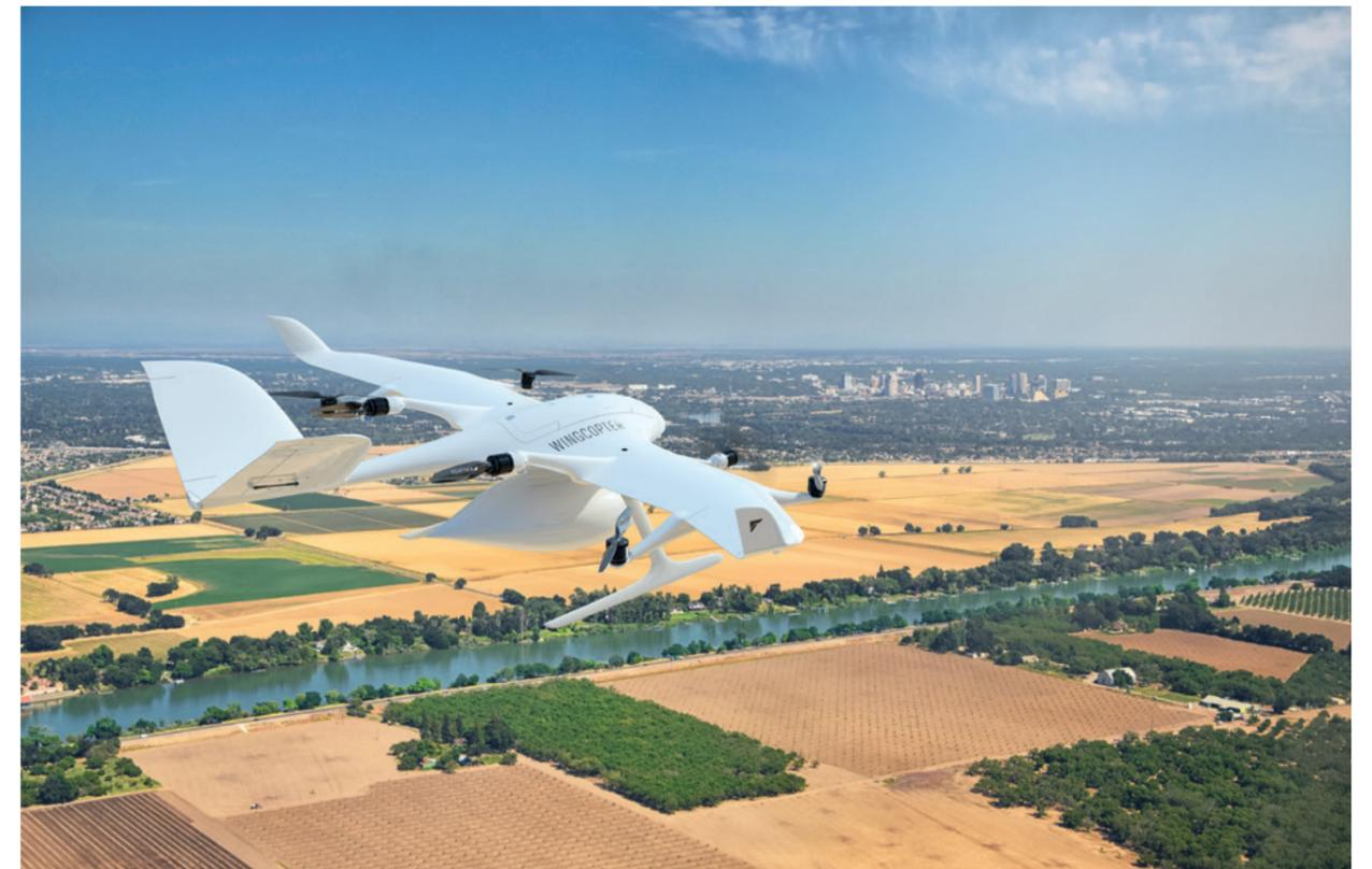
Innovation in Hessen - senkrecht startend und rasend schnell. Die Schwenkrotoren-Drohnen eines Start-ups aus Weiterstadt für den Transport von beispielsweise Medikamenten, Laborproben und Impfstoffen in entlegenen Gegenden sind weltweit im Einsatz. Auch die Zukunft der Logistik wird heute in Hessen geschrieben.
