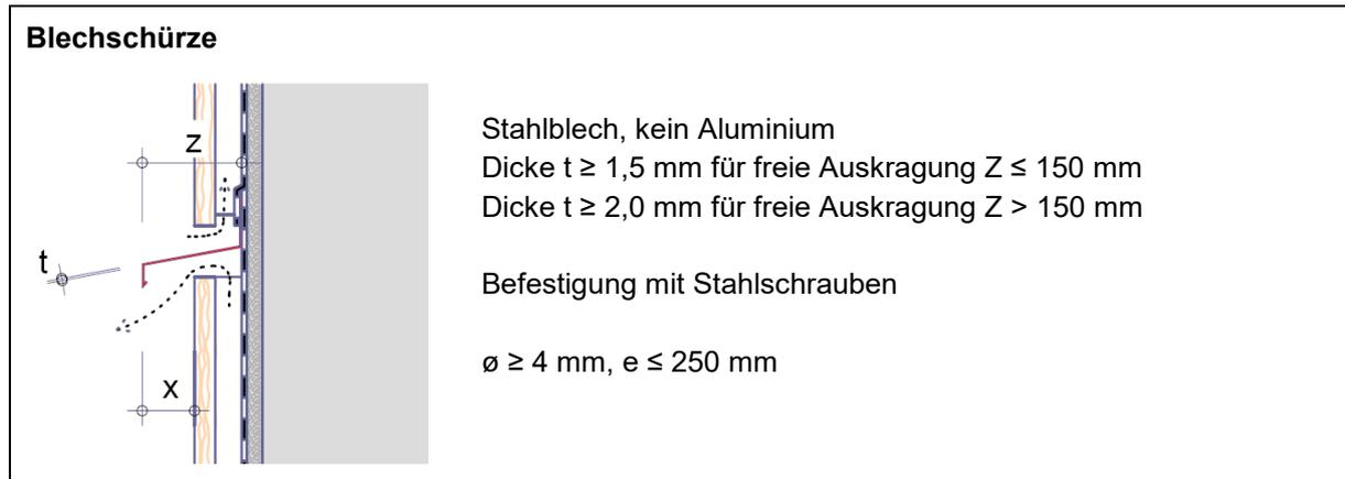
**Prinzipskizze 14:** Ausführung und Befestigung von horizontalen Brandsperren (Z = Maß der Auskragung, X = Mindestauskragung Brandsperre, siehe Tabelle 3)
