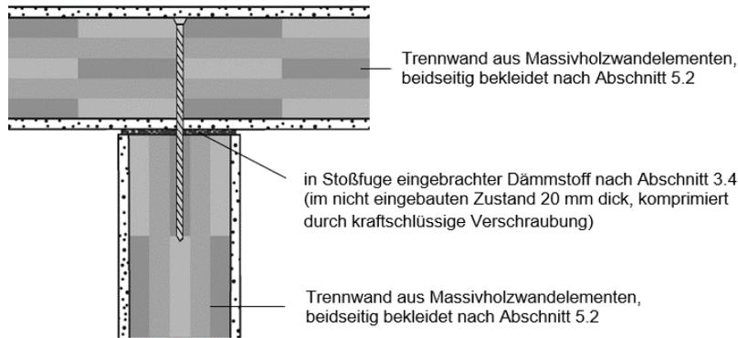
Prinzipskizze 8a: Anschluss Trennwand / Trennwand, Bauteifuge (Horizontalschnitt)
