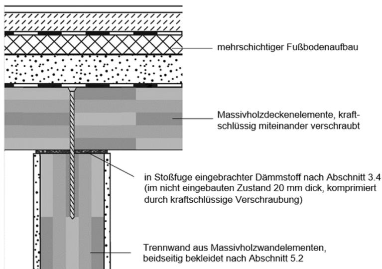
Prinzipskizze 8c: Anschluss Trennwand / Massivholzdecke, Bauteifuge (Vertikalschnitt)
