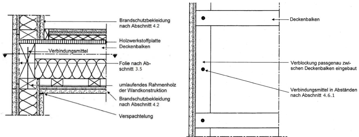
**Prinzipskizze 1:** Anschluss Decke an tragende und raumabschließende Wand mit Brandschutzbekleidung, z. B. Treppenraum- oder Außenwand, Spannrichtung der Deckenbalken senkrecht zur Wand (links Vertikalschnitt, rechts Horizontalschnitt)
