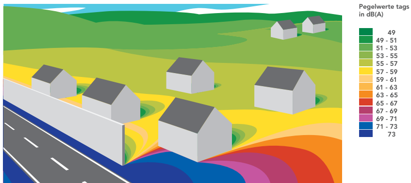
Bild 2 zeigt, dass die Lärmschutzwand zwischen Straße und Wohnhäusern die Ausbreitung des Schalls begrenzt. An den Gebäuden hinter der Lärmschutzwand haben sich die Pegelwerte auf 57 bis 59 dB(A) reduziert und die Lautstärke liegt damit unterhalb des in der 16. BImSchV definierten Bereichs.
